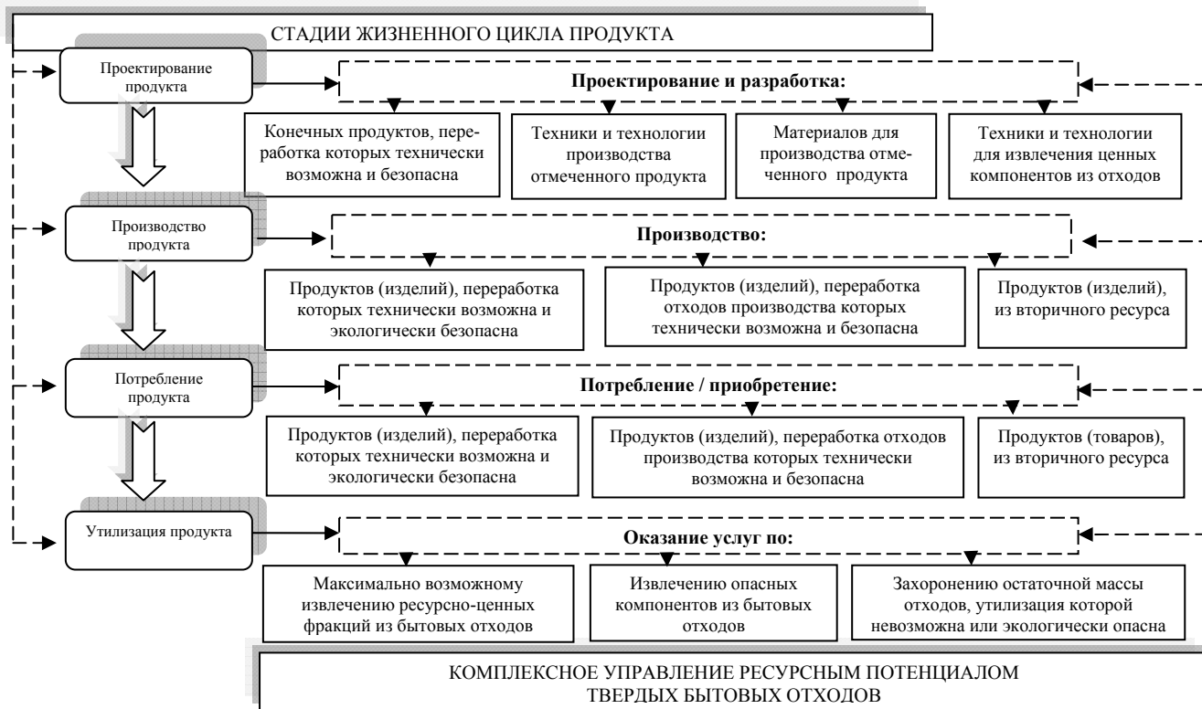
Рисунок 1 – Направления комплексного управления ресурсным потенциалом твердых бытовых отходов по стадиям жизненного цикла продукта
